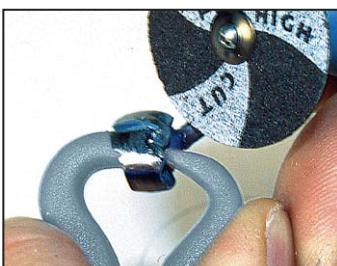
Ideale Halterung zum Abtrennen und Beschleifen von Gusskanälen
